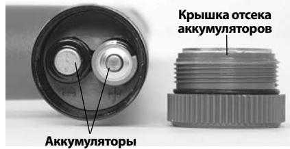
Рис. 7 – Замена аккумуляторов (приемник)
